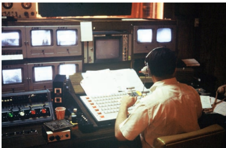
Первый в мире видеомикшер GVG 1400 в ТВ-аппаратной того времени (фото предоставлено сайтом www.flickr.com)
